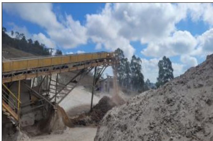
Foto 7: Pilha pulmão, com aspersão de água
