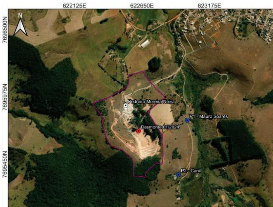
Figura 11: Pontos de medição sismográfica e do local de desmorte da rocha
