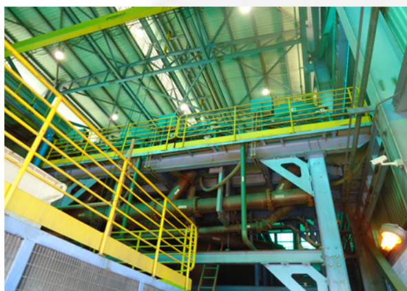
Foto 01. Vista inferior dos concentradores gravíticos Knelson QS48.
