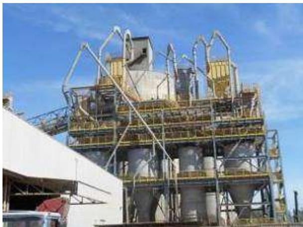
**Foto 05.** Silos diários para armazenamento das matérias primas.
