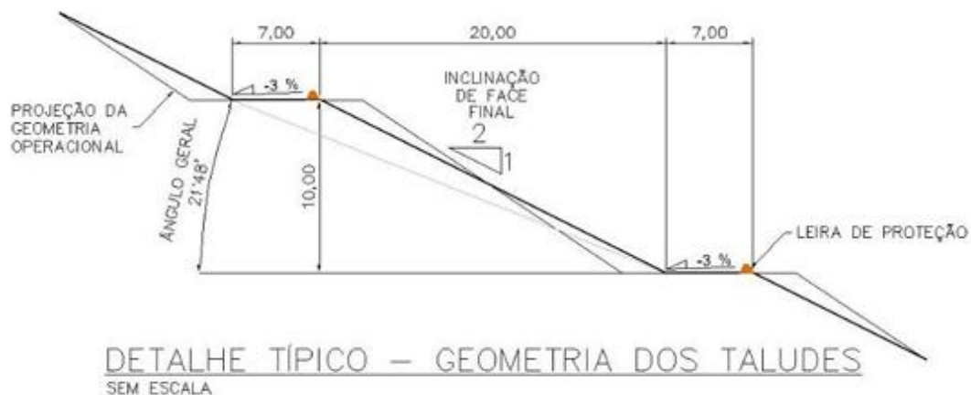
Figura 10. Detalhe típico da geometria da PDE Quartzito Fase 2 – dimensões em metro. Fonte: Documento SEI 111583502.
