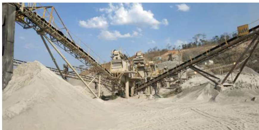
Conjunto de classificação de peneiramento. Fonte: RIMA (2019) Petra MG
