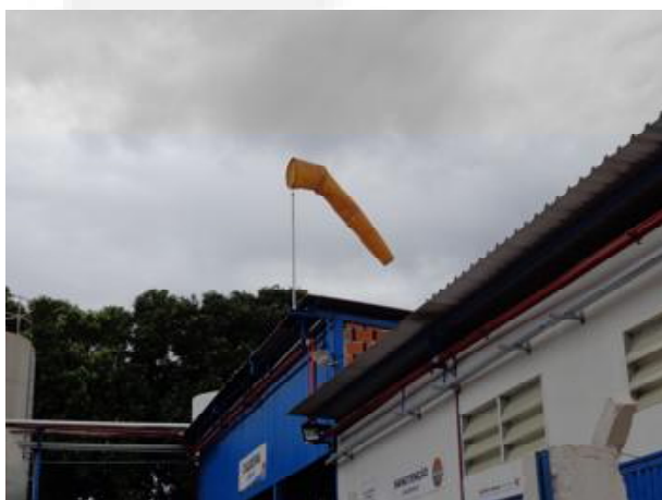
Foto 07. Biruta - medidor de direção dos ventos
