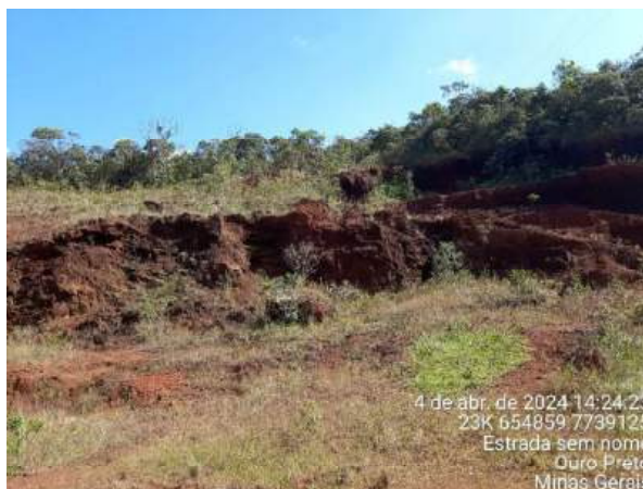
Foto 7: Detalhe de uma pequena bancada irregular formada com a retirada de minério.
