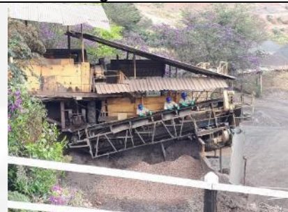
Figura 4. Processo de separação manual no beneficiamento
