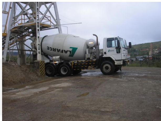
Foto 02 Sistema de carregamento da Betoneira.
