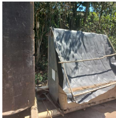
Foto 04. Peneira estática com tela de proteção contra aves
