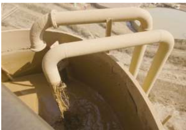
Figura 3 - Entrada da lama no espessador da filtragem
