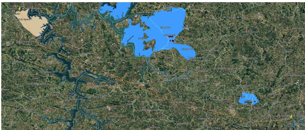
FIGURA 12 – Mapa em detalhe de Áreas de Ocorrência de Cavernas - LT 345 kV Furnas – Itutinga C1 em detalhe. As áreas coloridas representam áreas de possível ocorrência de cavernas (independente do potencial). As áreas sem cores, que predominam na imagem, representam áreas de ocorrência improvável. Os dois losangos vermelhos representam as cavidades existentes (próximos ao hachurado bege e ao azul). Fonte: Id. 400184 (SLA).
