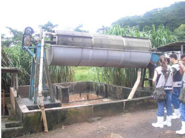
**Foto 5. Sistema de Tratamento Primário de Efluentes**
