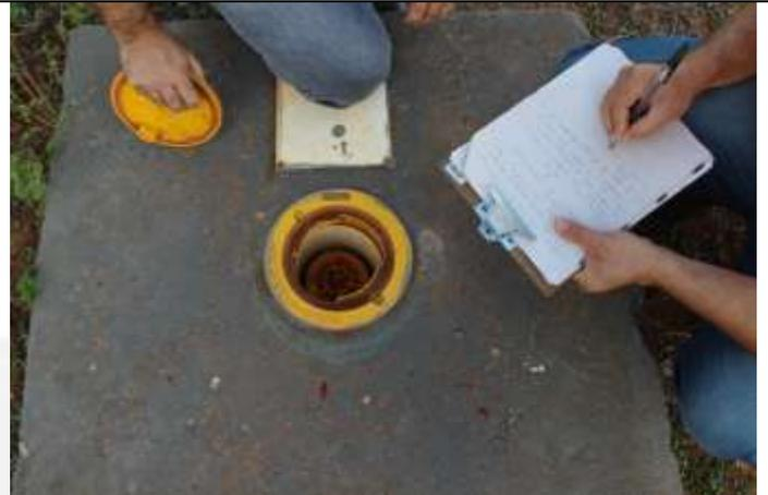
Foto 6: Poço de Monitoramento de Águas Subterrâneas
