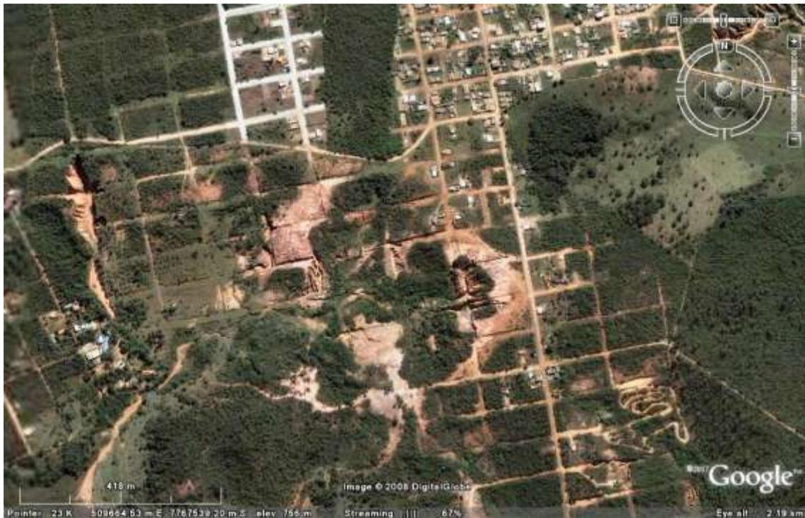
Imagem de satélite mostrando parte de uma área de loteamento em Divinópolis sem pavimentação das ruas e sem sistema de drenagem pluvial. Notar o avançado processo erosivo e as demais consequências ambientais e o risco à estabilidade geológica do terreno e às moradias.
