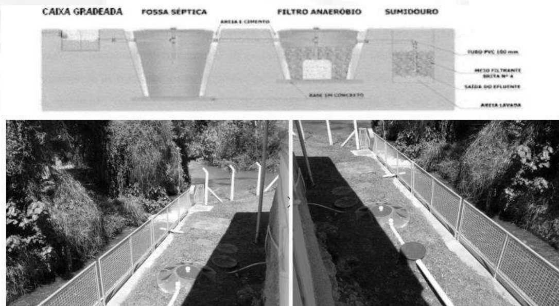
Sistema de Fossa séptica-Filtro-sumidouro ao lado da Casa de força
