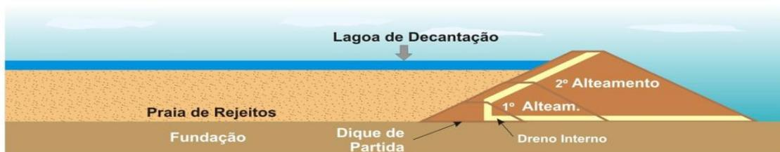
**Figura 4 – Seção esquemática da barragem Maravilhas III.**
