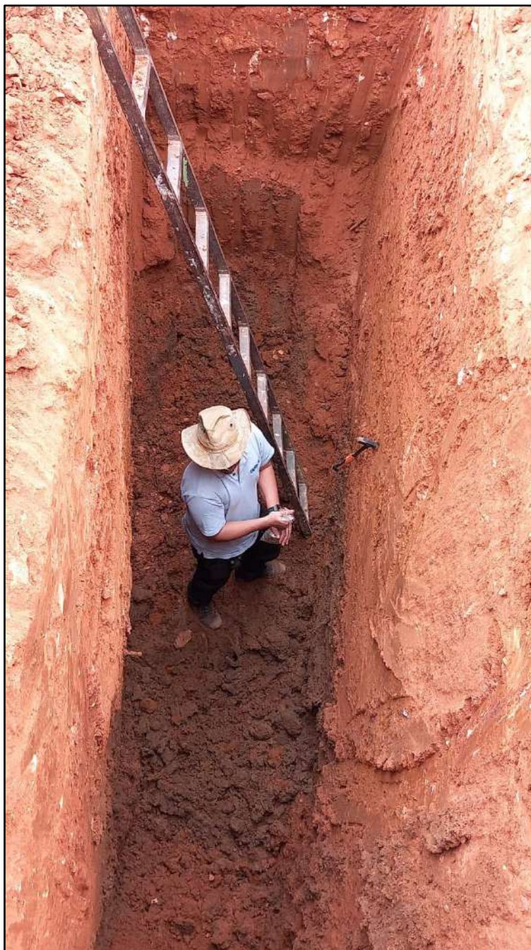
Figura 37 - Trincheira realizada no local.
