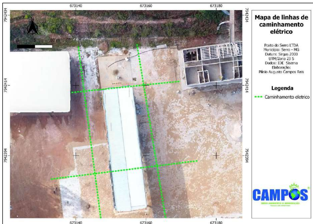
Figura 41 - Malha proposta para execução do levantamento de eletrorresistividade.
