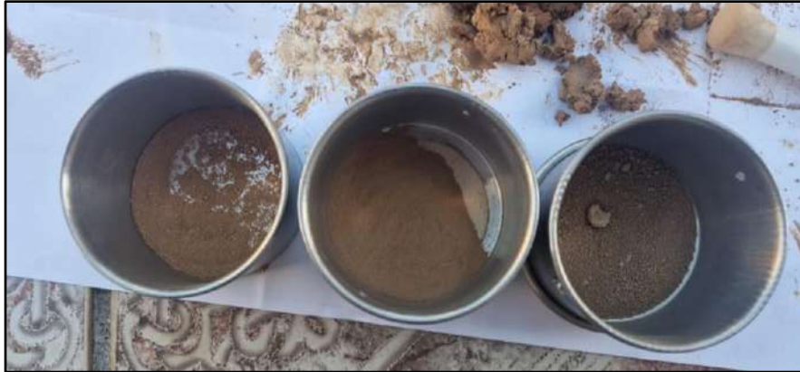
Figura 34 – representação do fundo e peneiras de 0,063 mm e 0,25 mm onde ficaram retidas as maiores partes das amostras.
