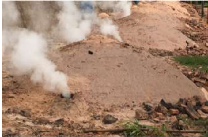
Situação Normal do Forno de Encosta: 3 chaminés
