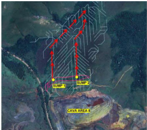
Figura 8: Imagem georreferenciada da Mina Segredo na região da Área 08 contemplando direcionamento de drenagem levando em consideração área de supressão futura.
