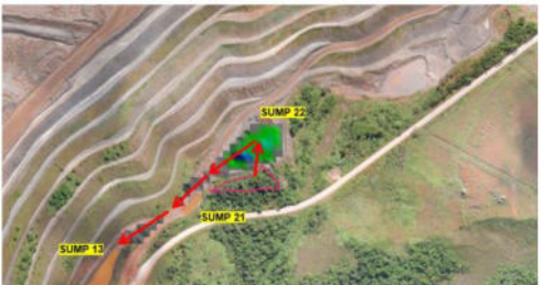
Figura 4: Imagem georreferenciada da Mina João Pereira na região da PDE Barnabé contemplando direcionamento de drenagem levando em consideração área de supressão futura.
