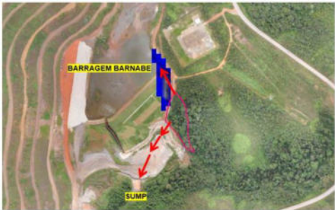
Figura 5: Imagem georreferenciada da Mina João Pereira na região da Barragem Barnabé contemplando direcionamento de drenagem levando em consideração área de supressão futura.
