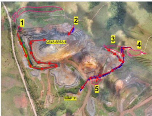
Figura 7: Imagem georreferenciada da Mina Segredo na região da Área 08 contemplando direcionamento de drenagem levando em consideração área de supressão futura.
