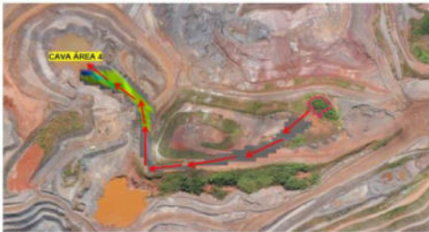
Figura 3: Imagem georreferenciada da Mina João Pereira na região da Área 04 contemplando direcionamento de drenagem levando em consideração área de supressão futura.
