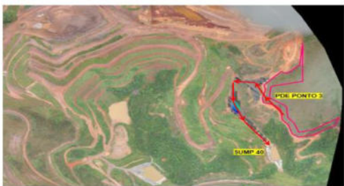
Figura 12: Imagem georreferenciada da Mina Segredo na região da PDE PONTO 3 contemplando direcionamento de drenagem levando em consideração área de supressão futura.
