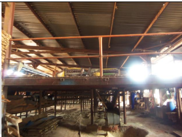
Figura 14 - Serraria suspensa (1,8 m do solo)
