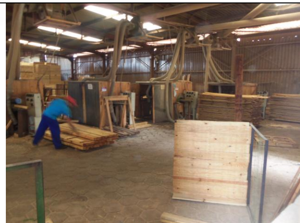
Figura 13- Local de serragem da madeira com os sistemas de exaustão de partículas finas (serragem)
