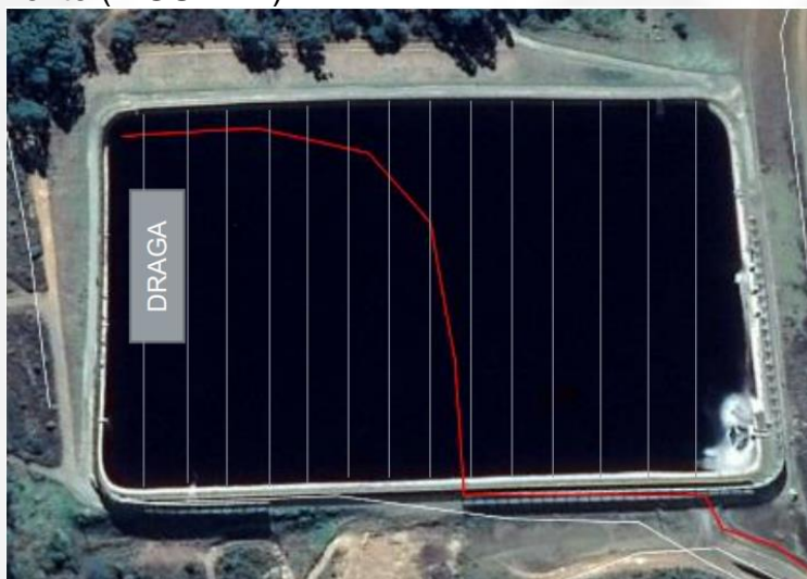
FIGURA 1 - esquema para ilustrar a movimentação da draga na superfície da ARB2,
