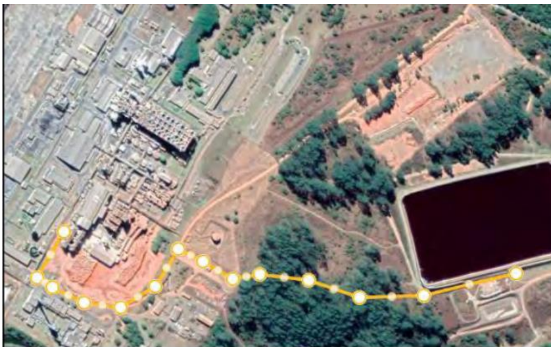
FIGURA 3 - trajeto da tubulação para lançamento do resíduo dragado nos filtros de resíduos de bauxita
