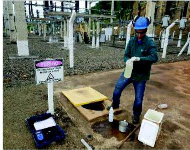
Figura 11: Coleta de efluente na saída da caixa SAO.
