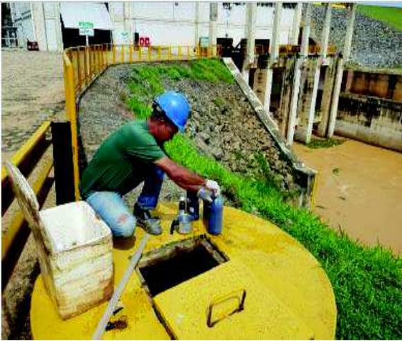
Figura 10: Coleta efluente na saída da ETE.
