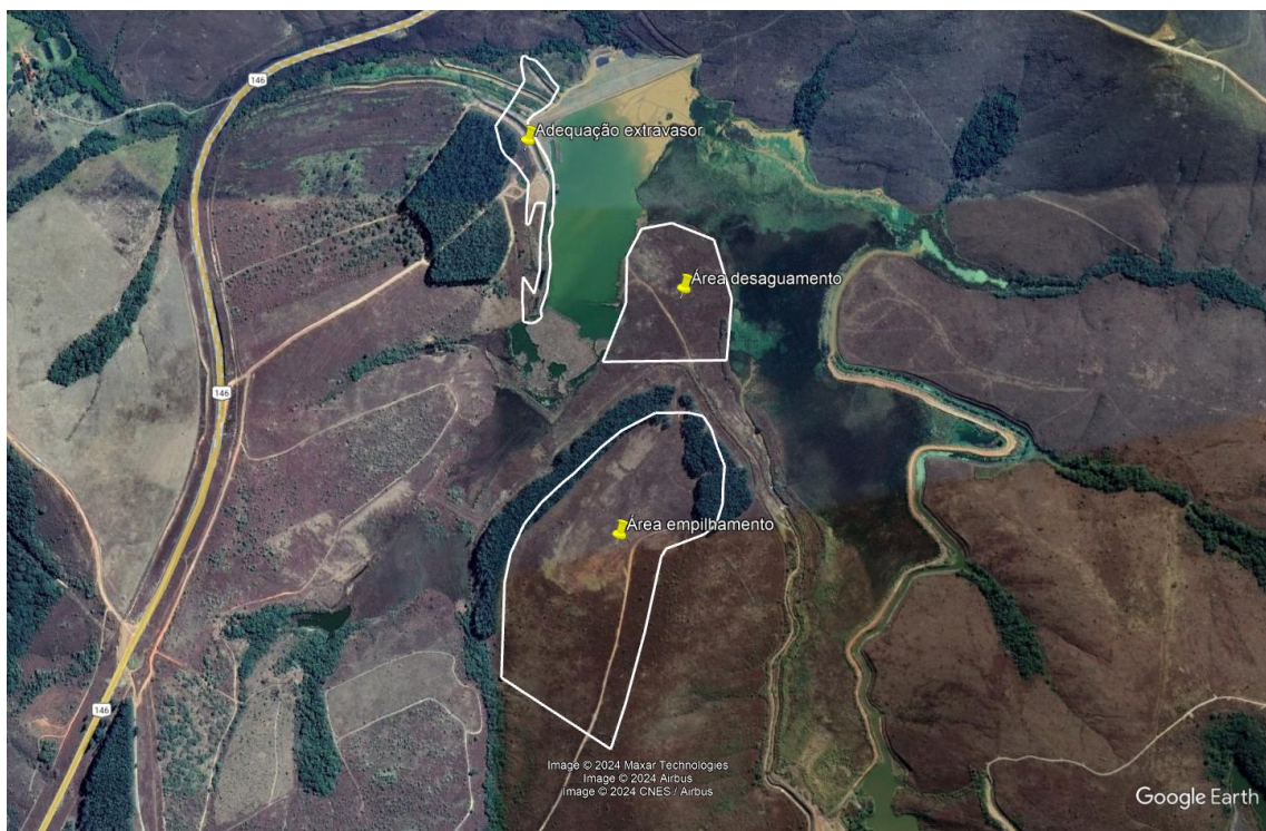
Imagem 01: Áreas de intervenção requeridas nesse adendo (adequação do extravasor, área de desaguamento e área de disposição do material retirado).
