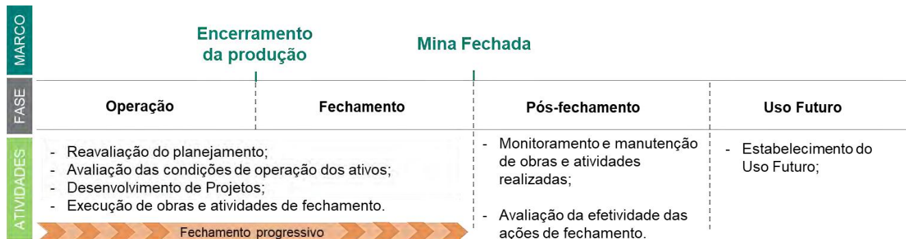
Figura 69 - Sequência das ações de fechamento. Fonte: Anexo 9 do PCA.
