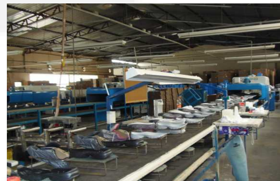
Montagem do solado no cabedal.
