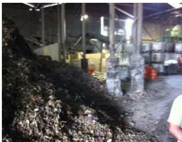
Foto 03. Galpão de blendagem contendo piso impermeável e fechamentos lateral e superior.
