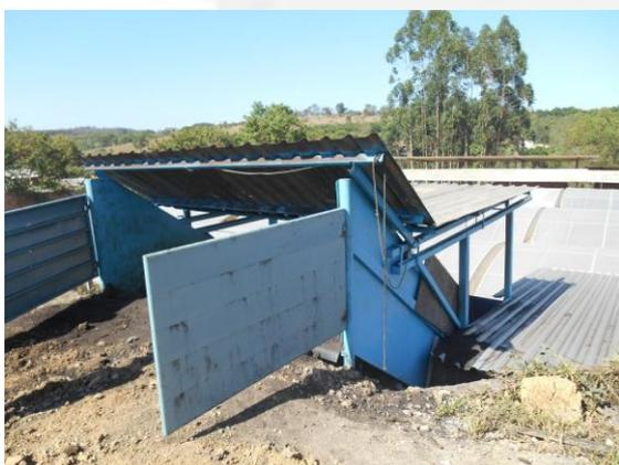
**Foto 15.** Dosador de pó de balão (a entrada deste após vistoria foi impermeabilizada).
