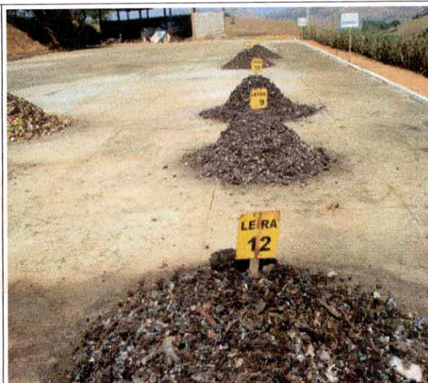
Foto 10: – Pátio de compostagem operante. As leiras são identificadas corretamente. Necessidade de aumentar o tamanho das mesmas. Havia trincas no pátio.
