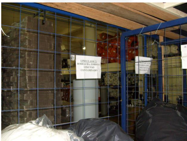
Foto 9. Baia de armazenamento de resíduos Classe I
