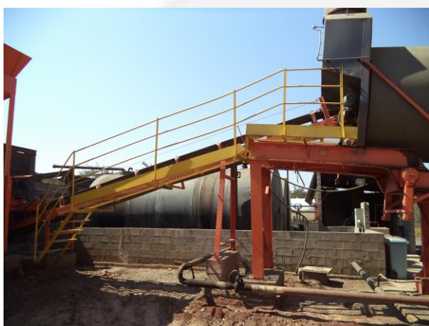
Foto 01. Tanque de Cimento Asfáltico de Petróleo (CAP) com contenção na usina de produção de concreto asfáltico.
