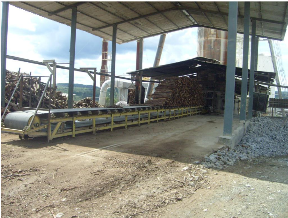
Foto 2: Alimentação do forno II através de correia transportadora.
