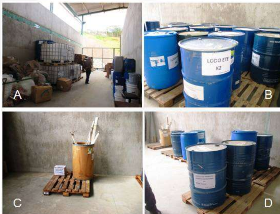
Figura 12 – Depósito de sólidos: resíduos recicláveis (A); depósito de resíduos perigosos (Classe I), lodo da ETE (B); acondicionamento de lâmpadas e produto fora de especificação (C); e acondicionamento de resíduos da produção (D).
