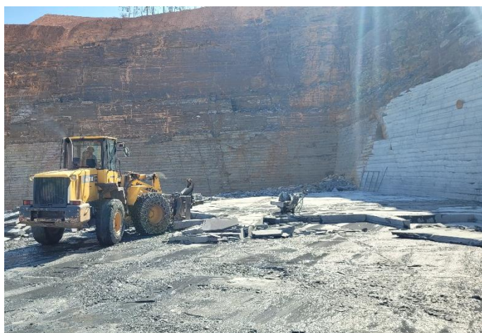
Figura 01: Extração dos blocos de ardósia. Fonte: URA NM, 2023.
