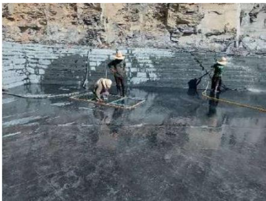
Figura 3 - Corte do piso de ardósia com carrinho de corte. Fonte: RCA Mineração Pecuária Morrinhos.
