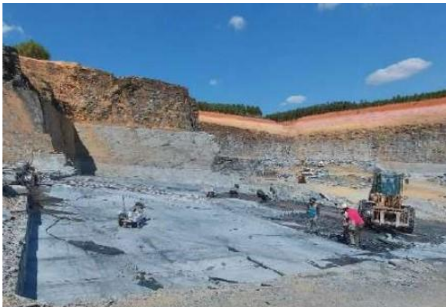
Figura 4 - Levante e carregamento das placas de ardósia que são levadas para beneficiamento ou venda.
