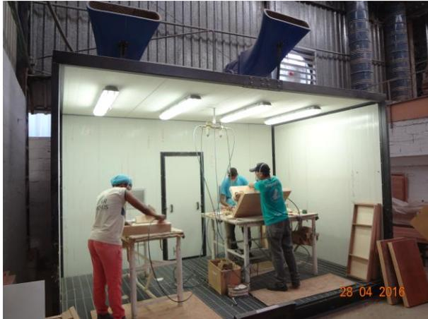
Fig. – Cabine de lixção com sistema de exaustão.
