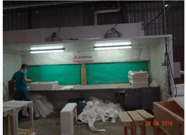
Fig. – Cabine utilizada para aplicação de cola.
