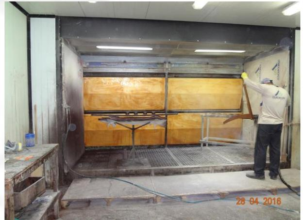
Fig. – Cabine de Pintura, com cortina d'água e recirculação.
