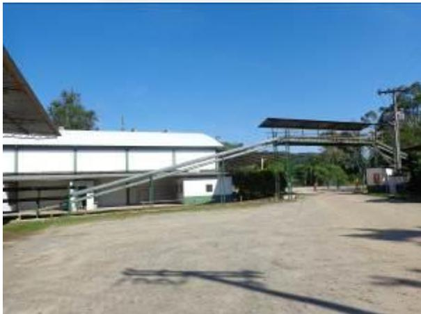
**Foto 07.** Esteira mecanizada de transporte de ovos
