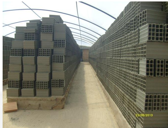
Foto 6: Estufas de secagem dos tijolos.
