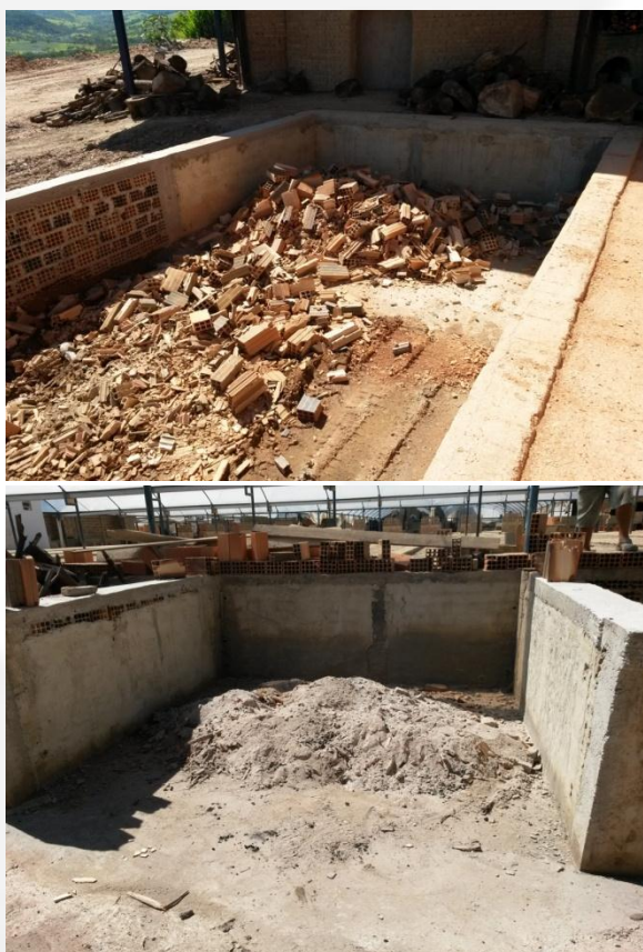
Foto 13: Depósito de cacos de tijolos queimados.
