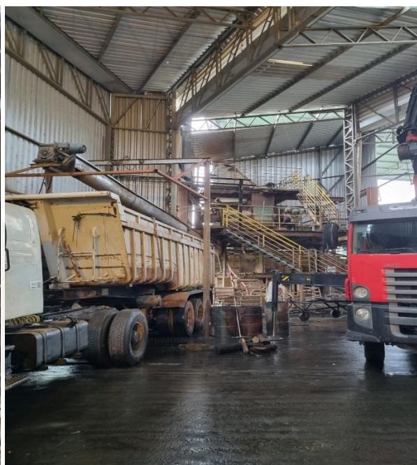
Figuras 11 e 12: recorte caldeiras e pátio com caminhões recebendo resíduos sólidos provenientes da linha verde e linha vermelha.
