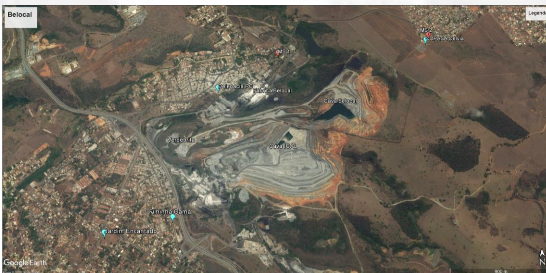
Figura 23: Detalhe da imagem anterior demonstrando as instalações (cava, britagem, fábrica, pilha de estéril) da mina, zona urbana e rural de São José da Lapa, pontos de monitoramento sísmográfico (MS1 e MS2) e atmosférico (COPASA, Delegacia PC, Filhinha Gama e Jardim Encantado). Fonte: Google Earth e FEAM.
