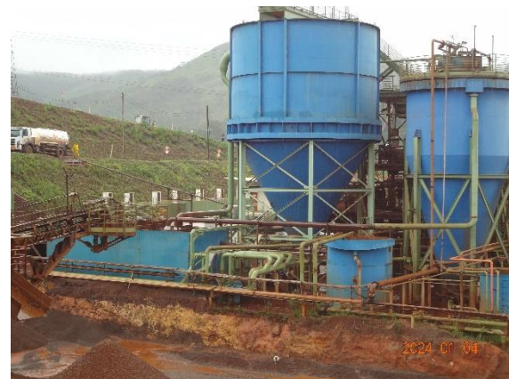
Foto 4 Tanques verticais azuis de decantação de rejeito. Caixa horizontal a esquerda de armazenamento de água recirculada.
