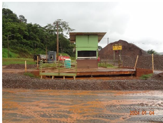
Foto 80 Balança de chegada que recebe os caminhões com matéria prima
