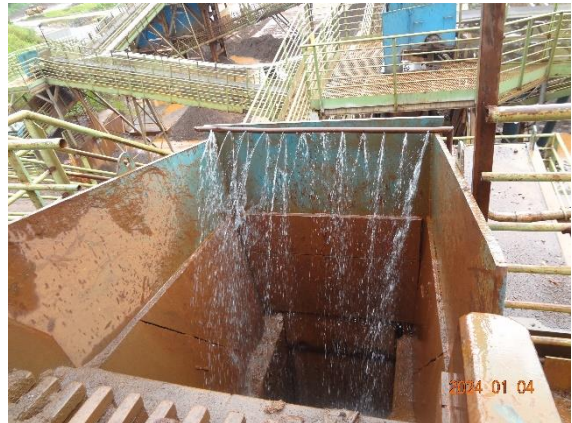
Foto 2 Sistema de umectação nos britadores.
