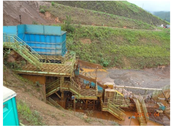
Foto 8 Britador primário e secundário da UTM Úmida.
