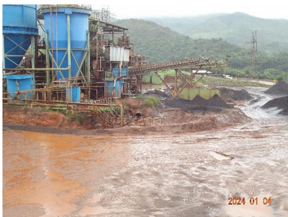
Foto 5 Sumps que recolhem todo sedimento carregado na planta. O material coletado é bombeado para a planta e reintroduzido no sistema de tratamento de minério.
