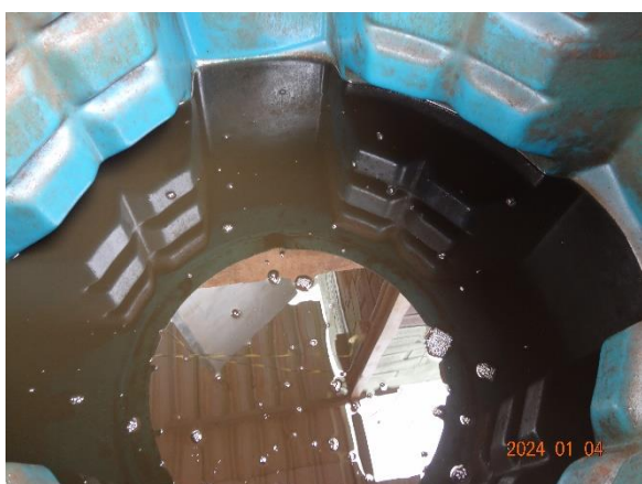
Foto 51 Recipiente de coleta de borra de óleo da CSAO da unidade de Filtro Prensa de Rejeito
