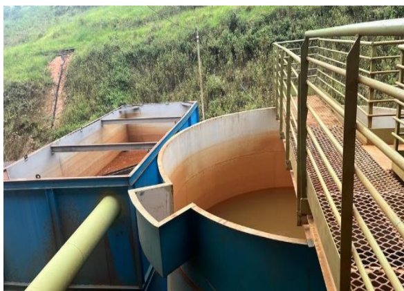
Foto 13 Tanque de rejeito na unidade de Filtro Prensa
