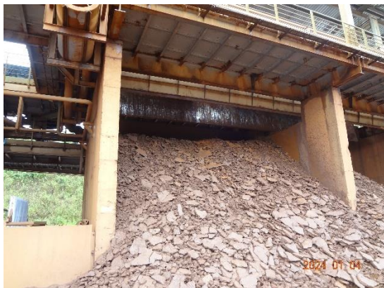
Foto 17 Rejeito filtrado liberado do sistema.
