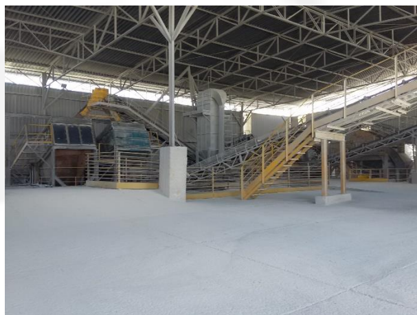
Foto 06. Galpão de britagem e moagem: detalhe para filtro de mangas.
