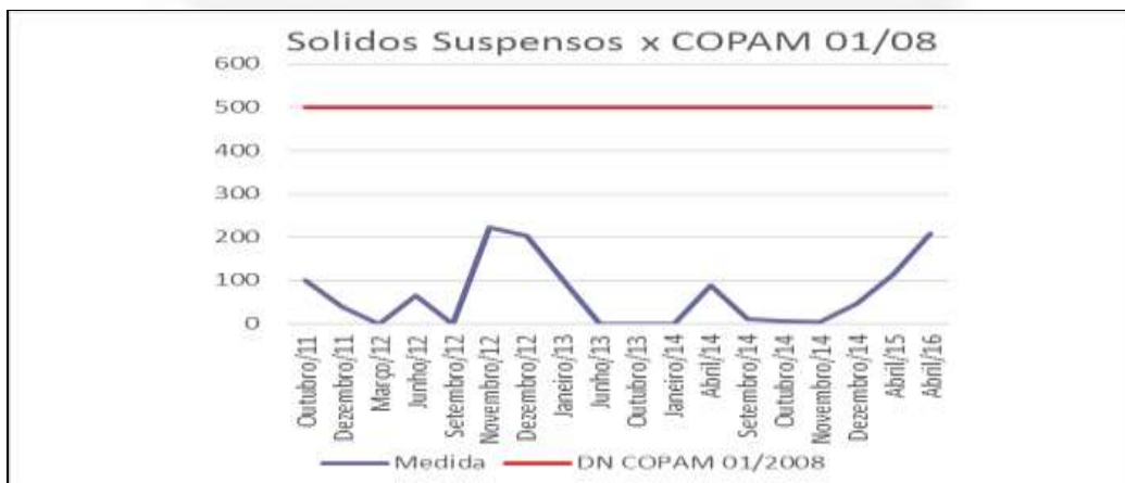
Figura 05: Concentração de Sólidos Suspensos na saída da ETE.
