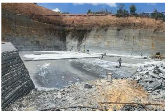
Foto 03 - Área da mina sendo lavrada. Demonstrando o direcionamento da lavra no sentido sul. Pode ser observado que o sedimento gerado no corte da rocha é direcionado ao fundo da cava.
