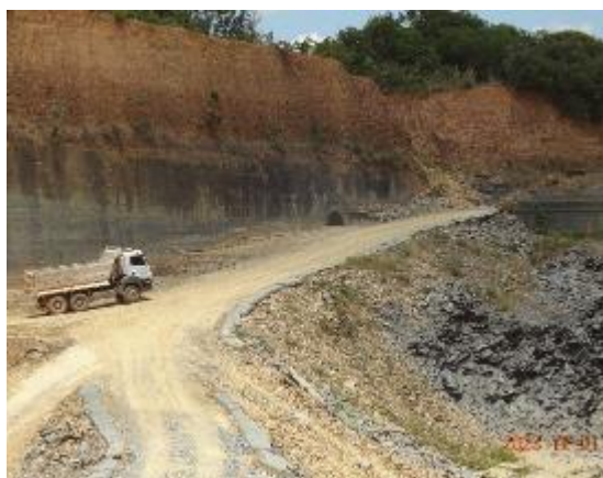
Foto 05 - Material de descarte utilizado para direcionamento de água pluvial e controle de processos erosivos na cava.
