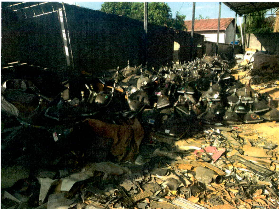
Foto 4 - acumulação inadequada de tubos de imagem diretamente sobre o solo, expostos a intempéries, empilhados sem qualquer critério para evitar trinca e quebra do vidro ou abertura do tubo promovendo a exposição de substâncias perigosas para o ambiente.
