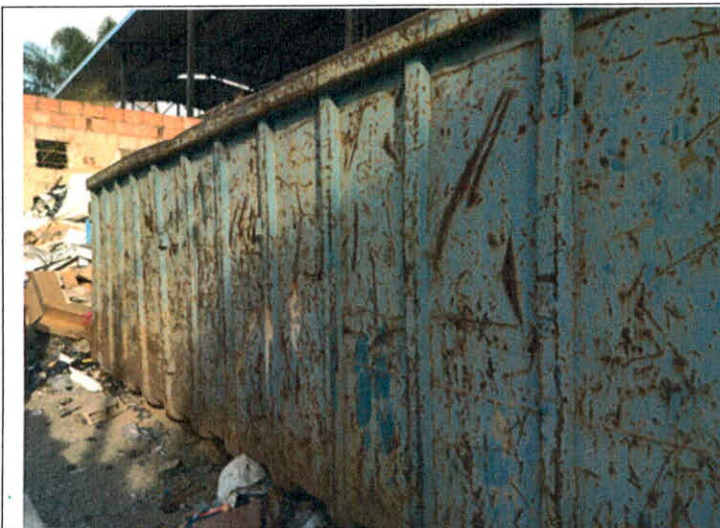
Foto 3- Caçamba para armazenamento de sucata ferrosa com capacidade de 3t e com cobertura parcial.
