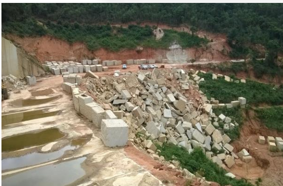
Foto 5. Pilha de rejeito/estéril.
