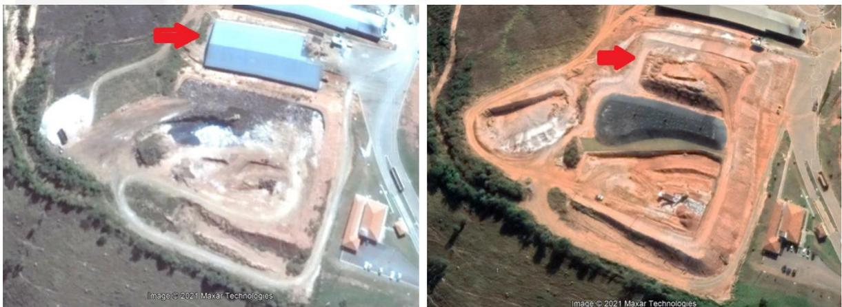
Figura 9: Aterro classe I – vista da vala 1 (pilha sul) no início da operação com a cobertura de galpão (à esquerda) em 2015 e vista no fim da operação (à direita) em 2021. Fonte: Google Earth
