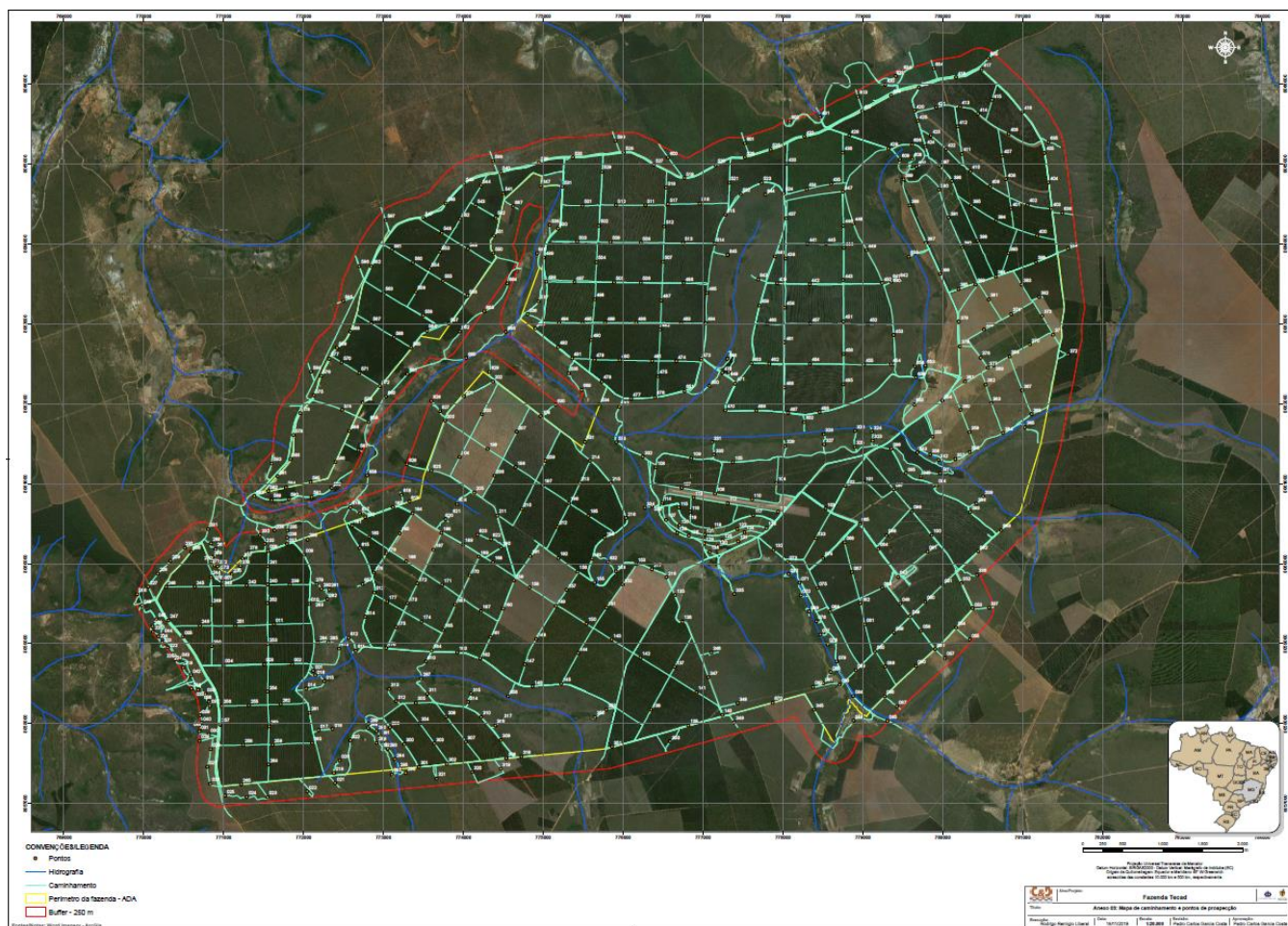
Figura 03 – Mapa confeccionado a partir do caminhamento ou prospecção espeleológica realizado na ADA do empreendimento (destaque em verde) bem como os pontos de controle (destacados de laranja) e o entorno do empreendimento (buffer de 250 metros a partir da ADA, destaque em vermelho). Fonte: Estudos ambientais apresentados.
