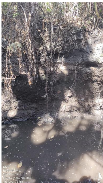
Figura 28. Espesso depósito de “rejeitos” do processo siderúrgico exposto pelo entalhe da drenagem. Podem ser observadas camadas de escória e material de granulometria areia/silte de coloração escura. Ponto 9.
