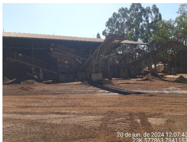
Foto 106: Unidade de peneiramento de minério localizada ao lado do galpão de finos de minério.
