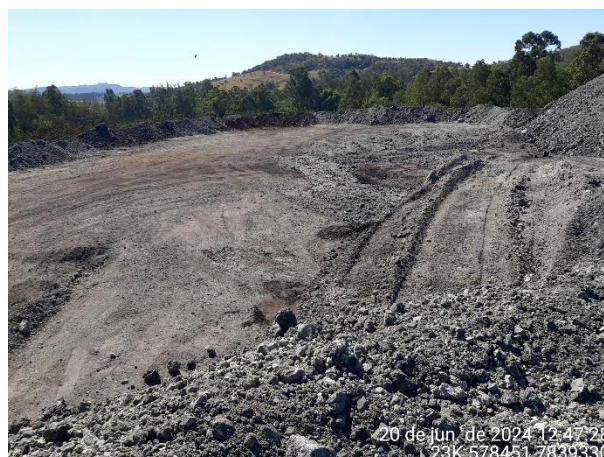
Foto 82: Parte alta da pilha, com indícios de deposição de escória recente.
