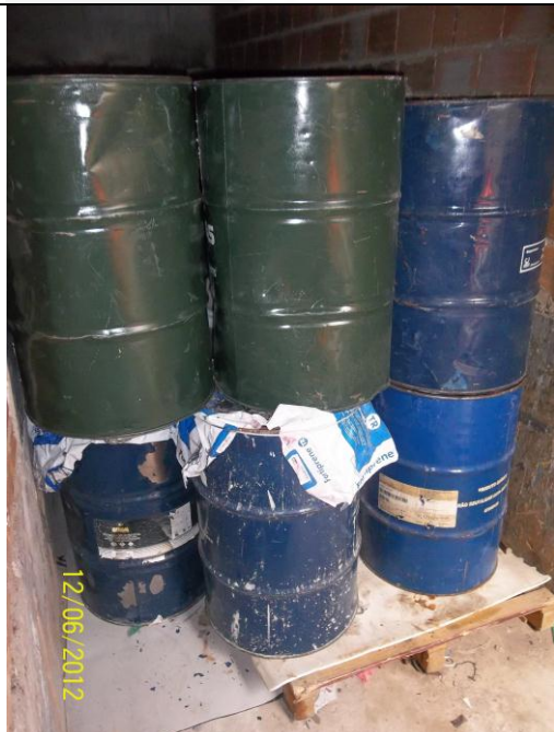
Foto 04. Resíduos classe I líquido. Ressalta-se que foi implantada bacia de contenção no depósito.
