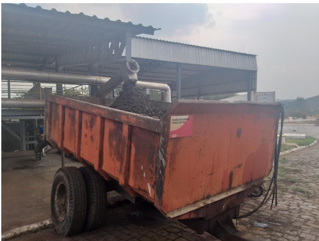
Vista da carretinha para a retirada dos sólidos
